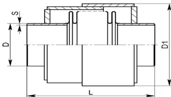
Основные параметры компенсаторов сильфонных стартовых типа SN
