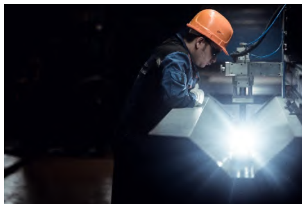
Автоматическая сварка обечаяек
